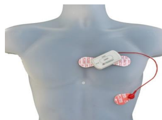
Patch a due elettrodi con cavo supplementare per 3 derivazioni (3CH)
